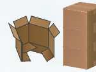
従来品は側面一重構造のため 耐荷重20kg、積み上げ3段
